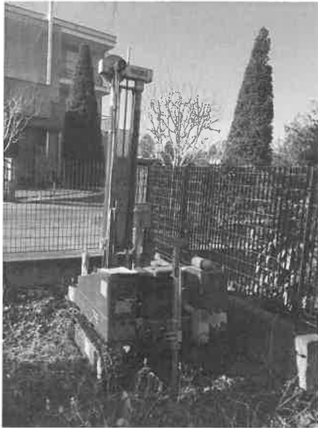
Foto 5: Esecuzione prova scpt
